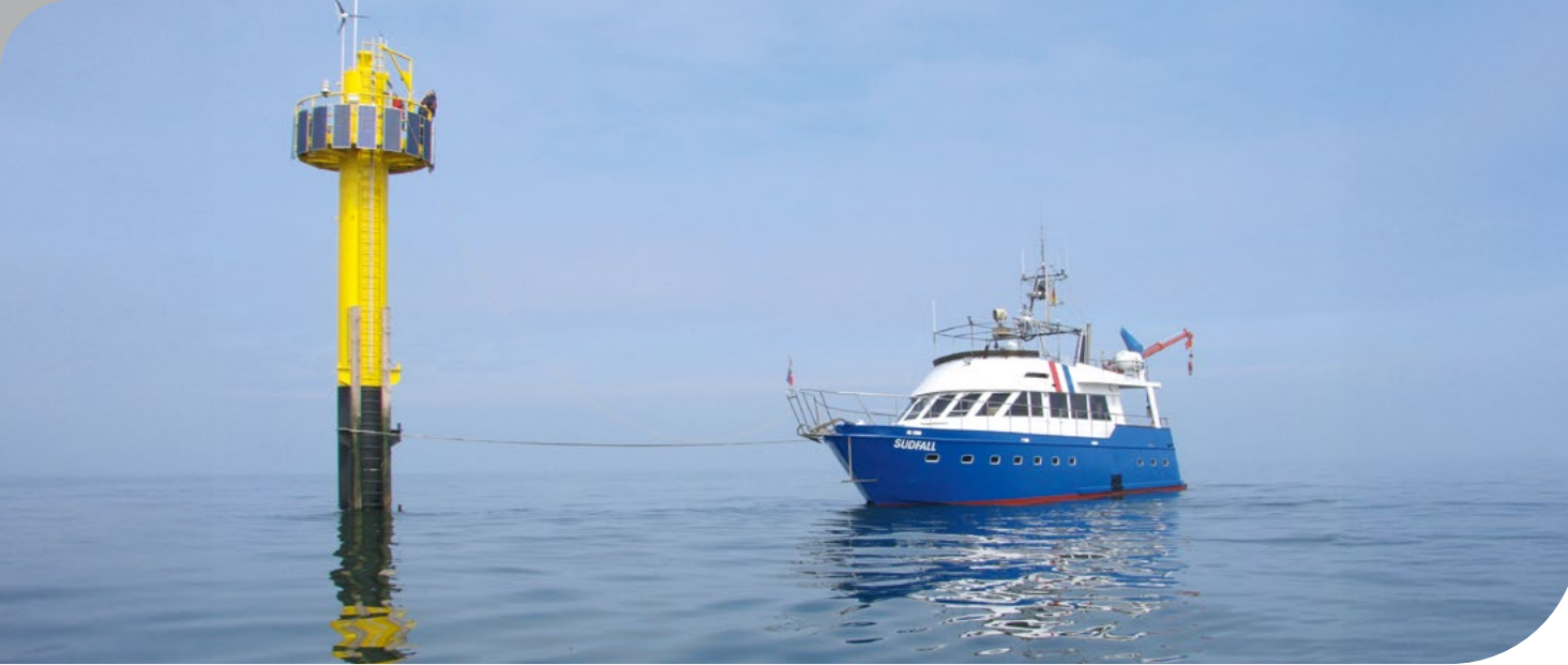
Vom FTZ im Rahmen des Nordsee-Monitoring-Projektes (NMS/OMS) errichteter autark arbeitender Messpfahl Rochelsteert in der Nordsee vor Eiderstedt bei Wartungsarbeiten mit dem FK Südfall in 2007. © Foto: K.H. Vanselow
